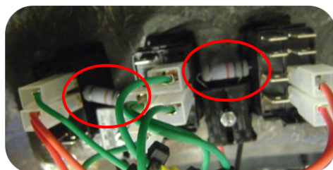
1 resistor de 220 OHMS entre cada botão
